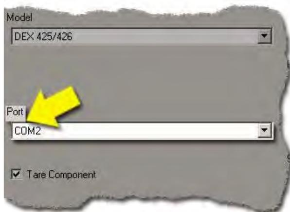
Il campo Port si riferisce alla COM, o porta di comunicazione, alla quale è collegata la bilancia. Le porte di comunicazione si trovano dietro il computer e sono dotate di presa maschio a 9 pin. Le porte di comunicazione possono essere chiamate anche "seriali" o IO (Ingresso/Uscita). Il software supporta connessioni sulle porte COM 1-4, ma la bilancia dovrebbe essere collegata alla porta COM 2, secondo la configurazione standard di PPG.
