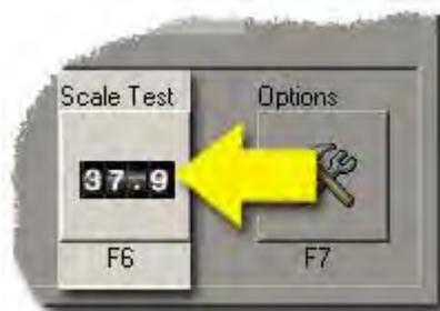
La schermata Scale Test serve per testare la comunicazione fra bilancia e computer. Se compare un messaggio d'errore, o la lettura a video non è sincronizzata con il display della bilancia, controllare le impostazioni della bilancia e la sezione Options del programma. Se tutte le impostazioni sono corrette ma il problema persiste, controllare prima i cavi di collegamento e le connessioni alla bilancia, poi chiamare il Color IT Helpdesk al numero 1-800-647-6050 per ricevere ulteriore assistenza.
