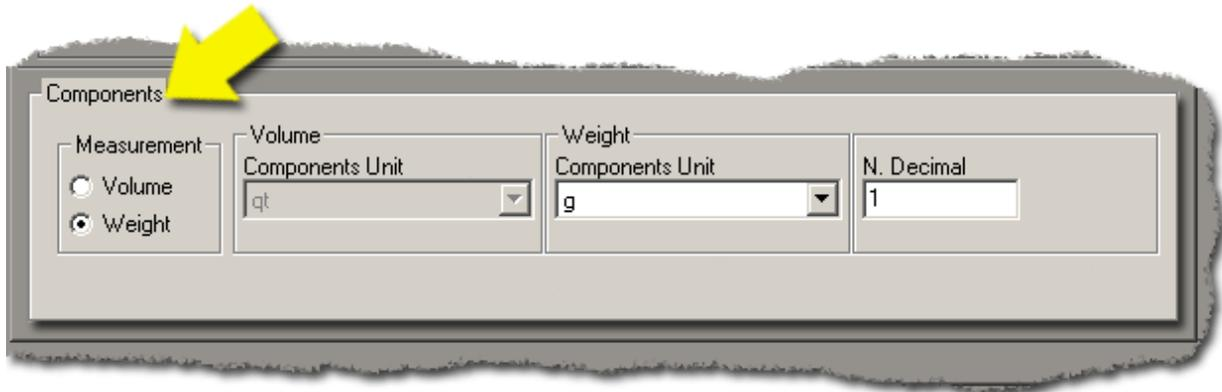
Nella sezione **Components** sono elencate le unità di misura per ciascun componente della formula o della ricetta configurata. In genere la misura viene impostata su "Weight", a sinistra della finestra.
